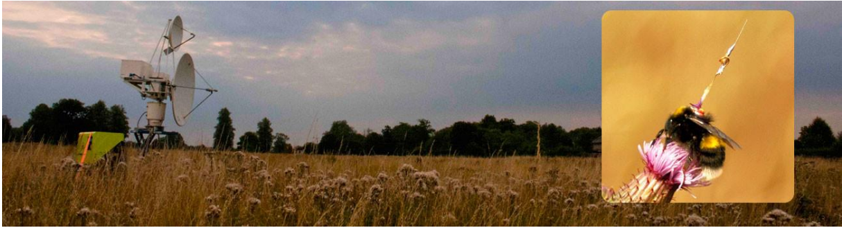
Figure 20 : Radar harmonique (à gauche) permettant de suivre automatiquement la trajectoire d'insectes portant un réflecteur, ici un bourdon (à droite). Source photo : http://www.rothamsted.ac.uk/news-views/radar-tracking-reveals-%E2%80%98life-stories%E2%80%99-bumble-bees
